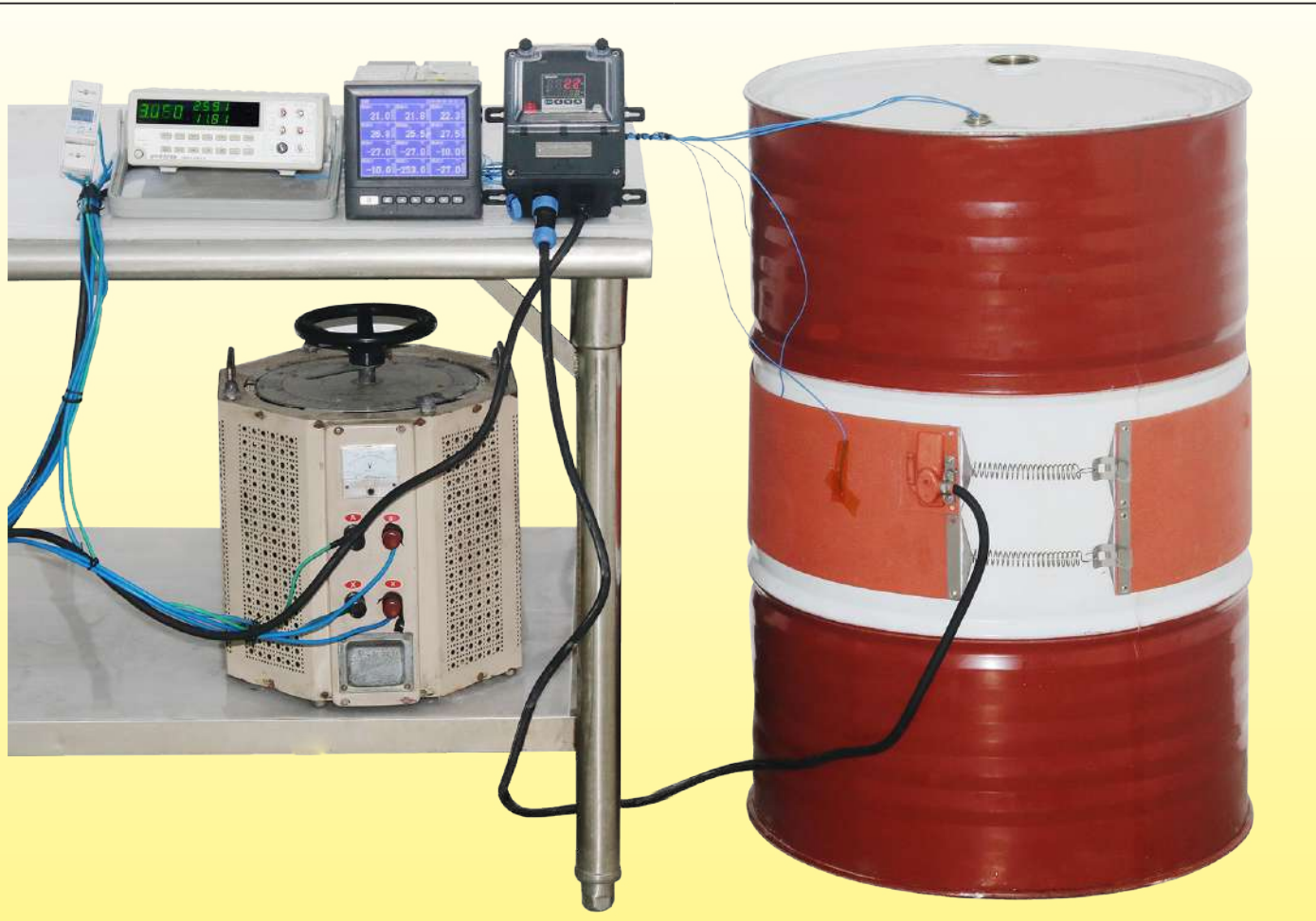
一个 220 升的金属鼓形桶的温度随时间的变化，填充水，通过一条 200mm 宽的硅胶加热带进行加热，不带保暖层，功率 1500W（表面负载 0.5W/cm 2 ）。
